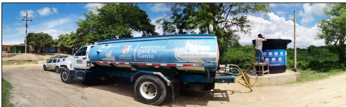
Descripción: Llenado de tanque de 5000 Litros con carro tanques
